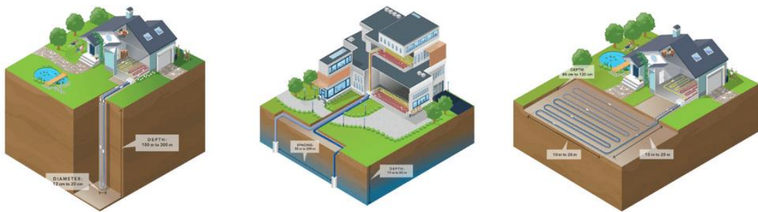
Figure 15 : Schéma des trois principaux dispositifs de captation de chaleur Source : Agence Parisienne du Climat
